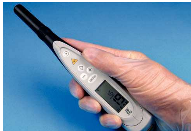
Figura 5. El lápiz DIAGNOdent (KaVo, Biberach, Alemania) fue desarrollado para el diagnóstico de la caries oclusal e interproximal.
