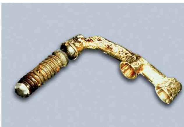
Figura 3c. Signos evidentes de acortamiento del implante y de desperfectos en la superficie causados por la pinza de sujeción.
