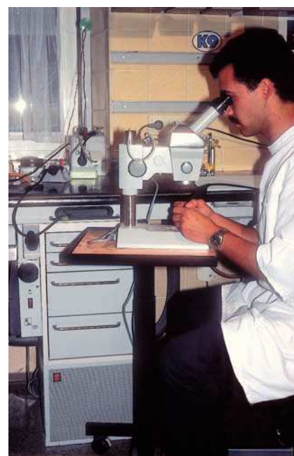
Figuras 43 y 44. Inspección de la impresión bajo el estereomicroscopio.
