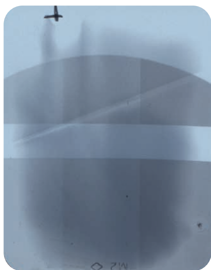
Figura 1. Imagen de constancia con manchas de productos químicos. La claridad es excesiva; el contraste, insuficiente.
