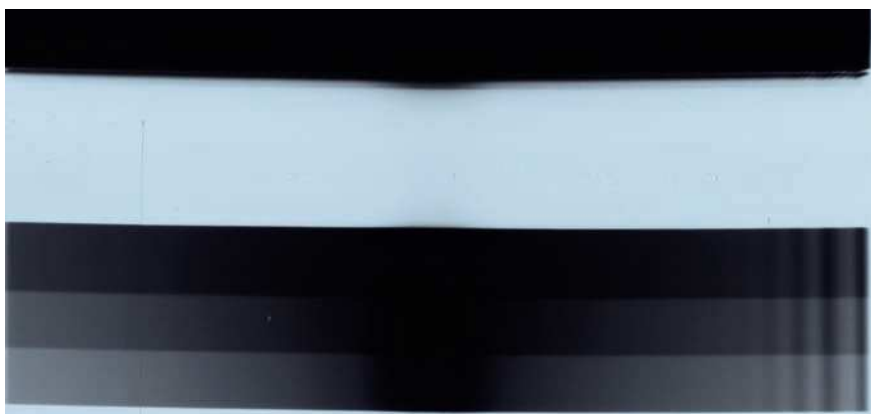
Figura 19. Imagen de constancia con rayas verticales.
