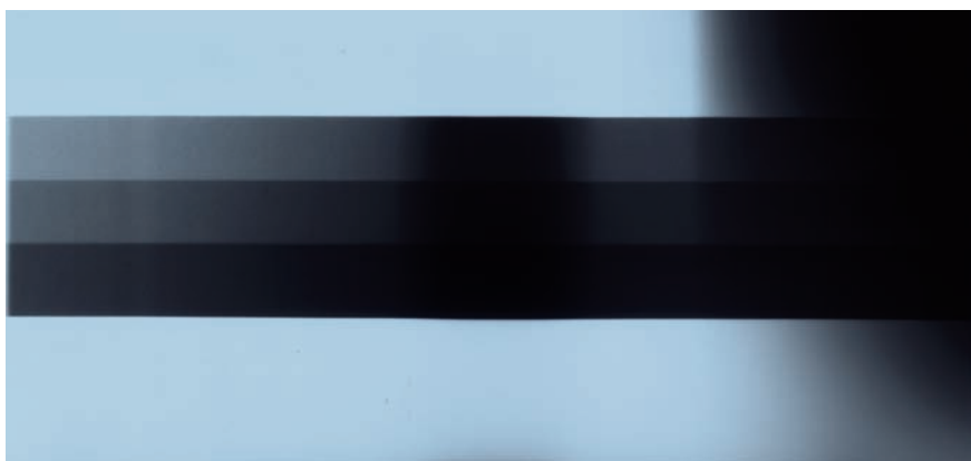
Figura 17. Imagen de constancia con incidencia de luz externa.
