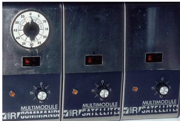
Figura 22. Sistema de acondicionamiento: baño 1: cocción; baño 2: conservación; baño 3: atemperación.
