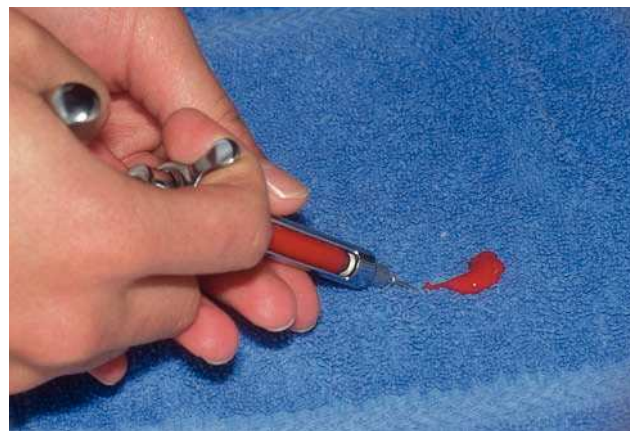
Figura 54. Prueba de fluidez con la jeringa cargada.
