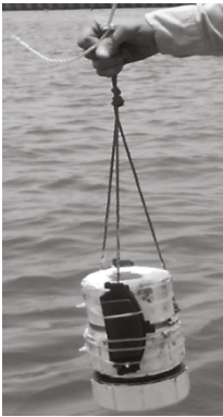
Figura 5. El transceptor submarino con pesos sujetos a la carcasa mediante cinchos a fin de hundirlo en el agua y realizar pruebas de campo. El transceptor de rastreo tiene la misma forma
