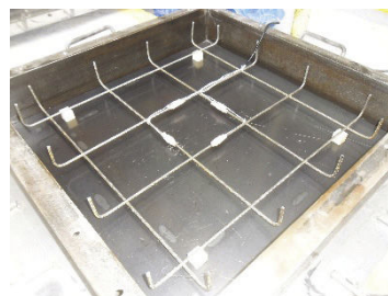
Figura 1. Geometría y configuración del refuerzo de la losa reforzada convencionalmente con malla electrosoldada: a) sección transversal, b) colocación de la malla
