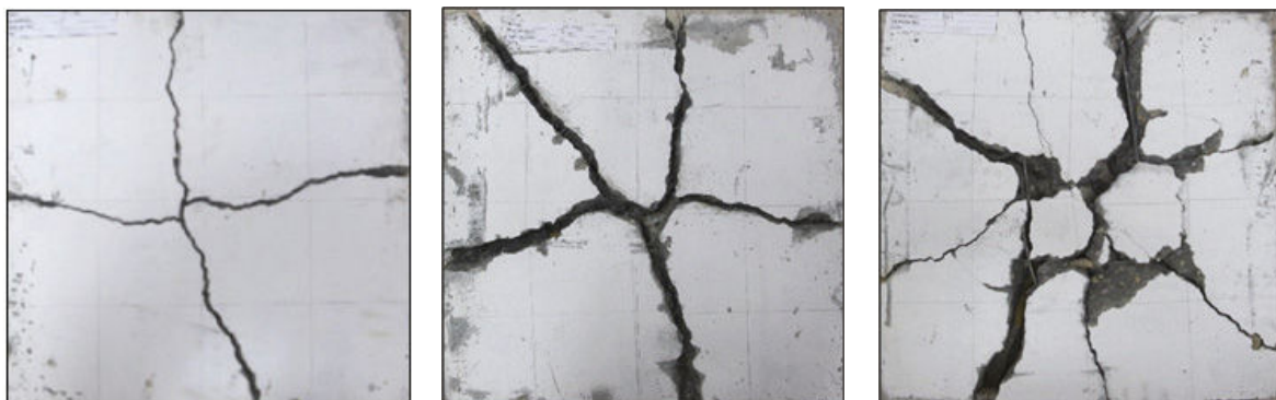
Figura 6. Esquemas de agrietamiento final de las losas: a) CS, b) D_f = 14.1 kg/m 3 , c) CR
