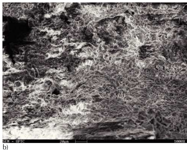
Figura 6. Observación microscópica, a) 500X de magnificación del acero en contacto con el concreto OPC, b) 1000X de magnificación de los productos de corrosión producidos por los procesos de degradación por el contenido del ion cloruro
