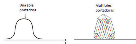
Figura 8. Comparación entre transmisión SC y multiportadora (OFDM)
