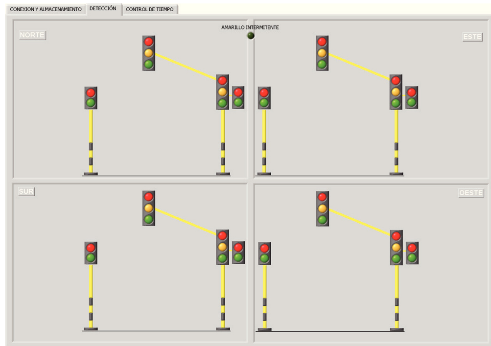
Figura 12. Visualización del estado de los bombillos de una intersección desde la central de monitoreo
