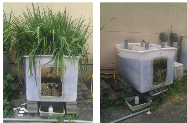
Figura 1. Humedales experimentales. Izda.: HFV2. Dcha.: HFV4 lecho sin vegetación
