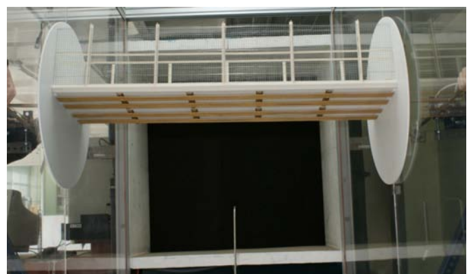
Modelo seccional de la pasarela de Cuenca
