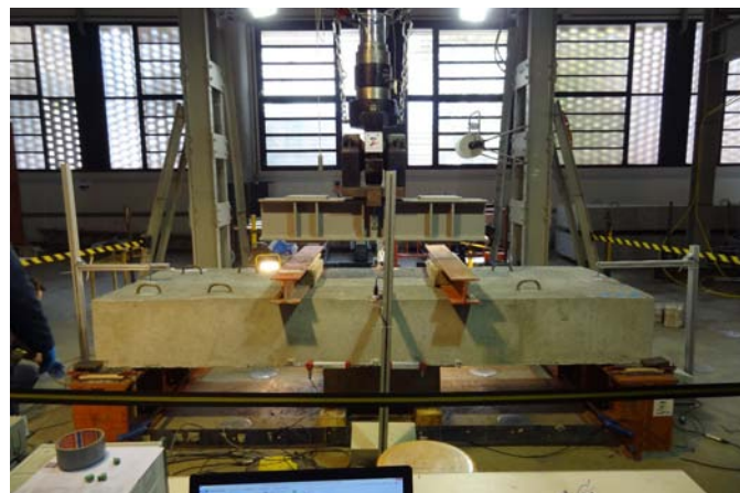
Figura 1. Configuración de apoyo para el ensayo de flexión a escala real
