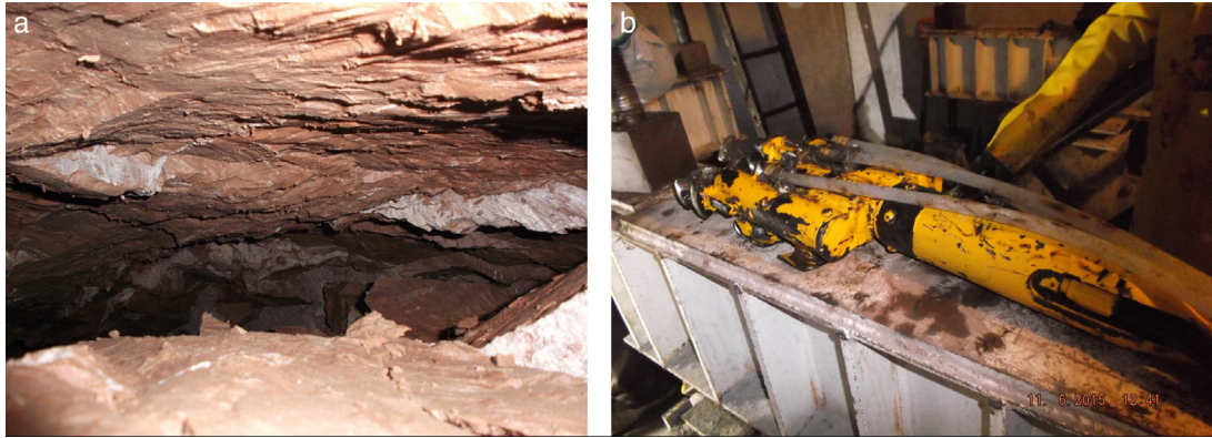
Figura 15. a) Extracción de material desde una ventana de subexcavación. b) Equipo de extracción de material, hidrotopo.
