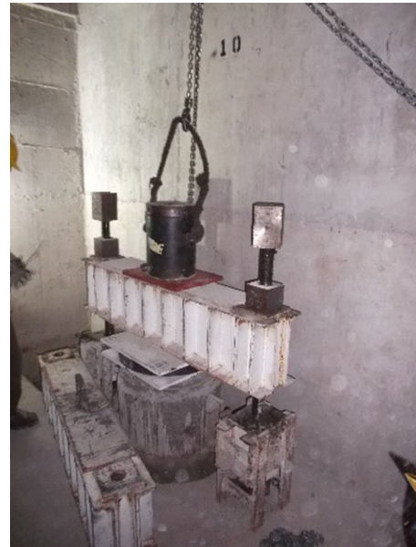
Figura 17. Ajuste de cargas en pilotes con gato hidráulico y puente de reacción.
