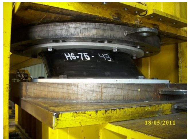
Figura 10. Ensayo dinámico sobre aislador sísmico.
