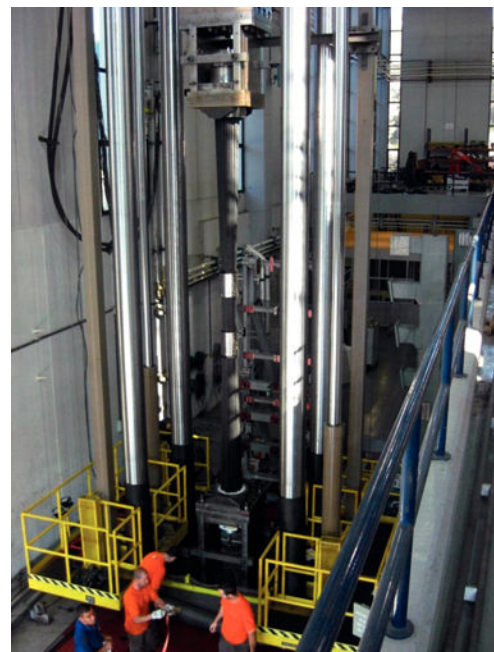
Figura 5. Ensayo de fatiga y rotura de tirante.
