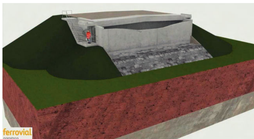
Figura 9. Modelo 3D de estribo con acceso a galería visitable.
