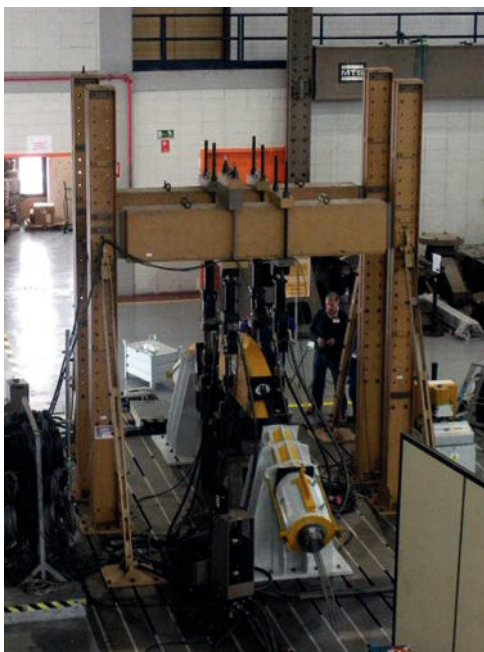
Figura 4. Ensayo de fatiga de la silla.
