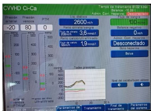
Figura 3 Pantalla de presiones del mismo tratamiento que la figura 2: tras reposicionar el catéter, las presiones empiezan a normalizarse.
