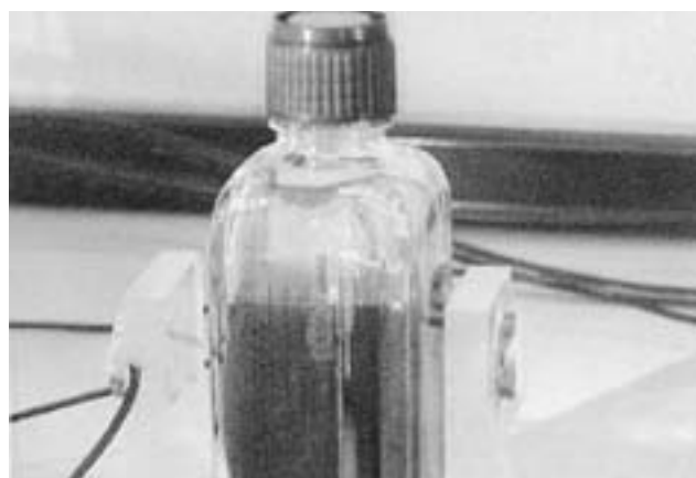
Figura 1. Frasco de cultivo con el sistema de transductores ultrasónicos antes de su introducción en el baño termostatzado.
