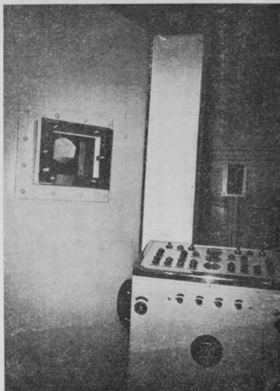
Fig. 6.—La cámara climática: a, interior; b, exterior.
