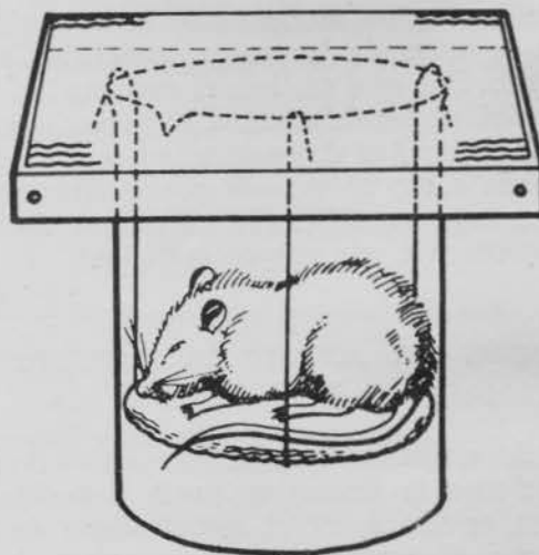
Fig. 2.—Jaula metabólica de fácil y barata construcción en el laboratorio.
