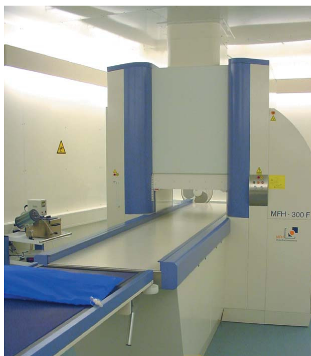
FIGURA 2. Aplicador de campo magnético alterno para uso en humanos (MFH300F, MagForce Nanotechnologies AG, Berlin) operando a una frecuencia de 100 kHz y a una fuerza de campo variable (0-18 kA/m). Una unidad termométrica de fibra óptica y una consola de ordenador con software para monitorizar en línea la termoterapia, están conectadas al aplicador.
