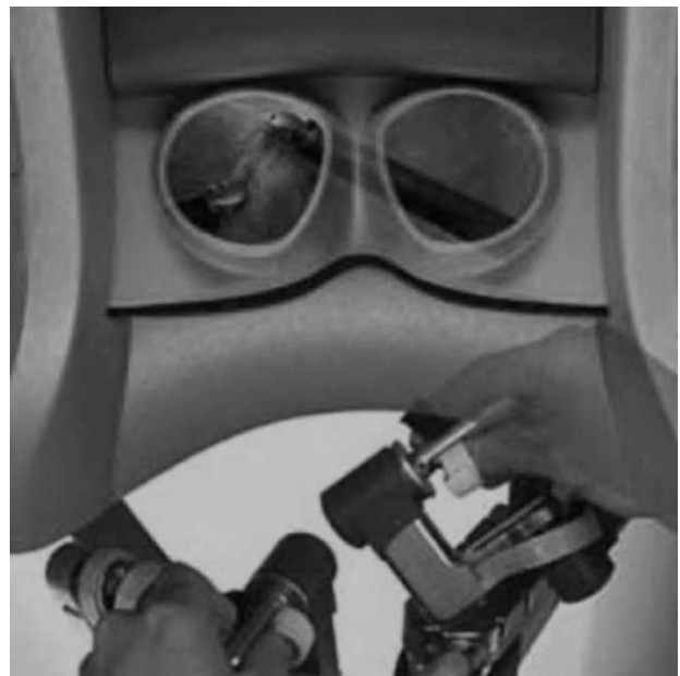
Fig. 2. Binoculares de visión estereoscópica del sistema Da Vinci.
