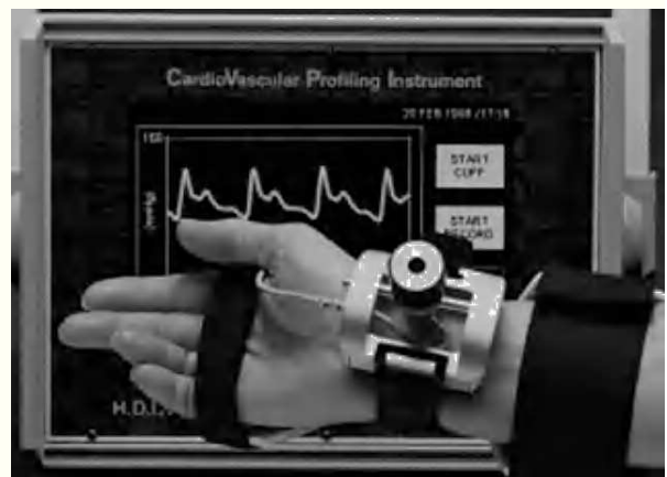
Fig. 2. Transductor y monitor para el análisis del contorno de la onda de pulso.
