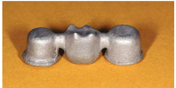
Fig. 4. Un armazón sinterizado por láser.
