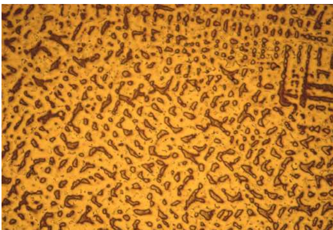
Fig. 9. La estructura dendrítica de una prueba colada.
