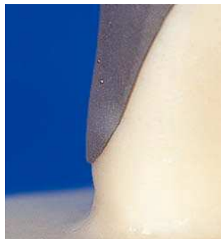
Fig. 11g. Estado después de un segundo tratamiento en caliente. No se observan deformaciones notables.
