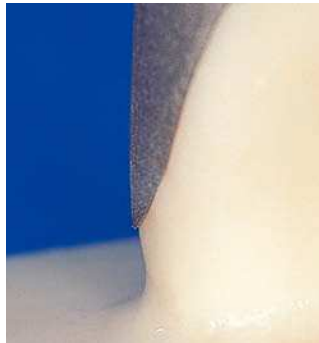
Fig. 11c. El estado de la aleación reducida de metales nobles después de la oxidación. Aquí apenas se pueden observar deformaciones.
