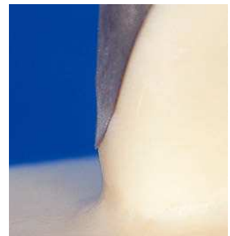
Fig. 11h. Después del segundo tratamiento en caliente. Efectivamente las aleaciones de metales nobles parecen deformarse más.
