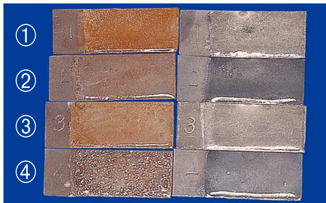
Fig. 6. En un ensayo sencillo se contrapusieron las aleaciones de color dorado y plateado que se utilizan más frecuentemente en la actualidad. Las aleaciones de color dorado tenían un grado de dureza de 220 HV (izquierda en la fig.). Los metales nobles de color plateado tenían un grado de dureza de 240 HV (derecha en la fig.).
