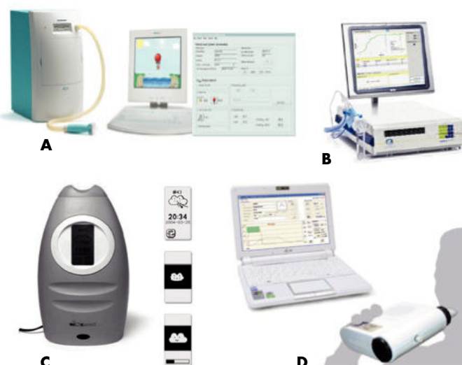
Figura 1. Comparación entre los aparatos de quimioluminiscencia (A: NIOX ® Aerocrine; B: ECO MEDICS Mod. CLD88sp) y los portátiles con detector electroquímico (C: NIOX-MINO; D: NO-VARIO Analyser).
