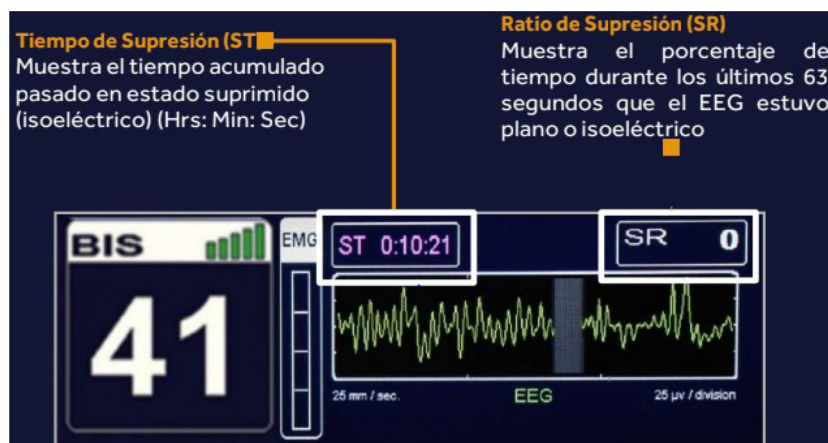
Figura 2. Tiempo de supresión (ST) y ratio de supresión (SR) en el monitor BIS®. Referencia: monitoreo de la conciencia. Medtronic®.
