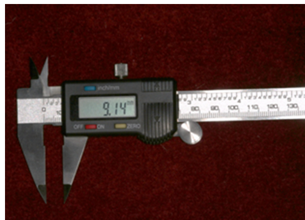
Figura 1 – Calibrador com escala Vernier com uma precisão de 0,01 mm.
