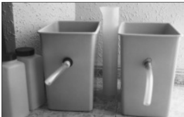
Fig. 1. Cubos y recipiente milimetrado utilizados en las mediciones.
