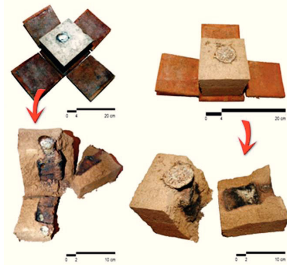
Fig. 7. Abertura do molde refratário e obtenção das peças de bronze.
