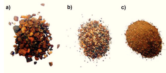
Fig. 4. Diferentes distribuições granulométricas de agregado: a) tamanho maior que 2 mm; b) tamanho entre 2 mm e 0,6 mm; c) tamanho menor que 0,6 mm.
