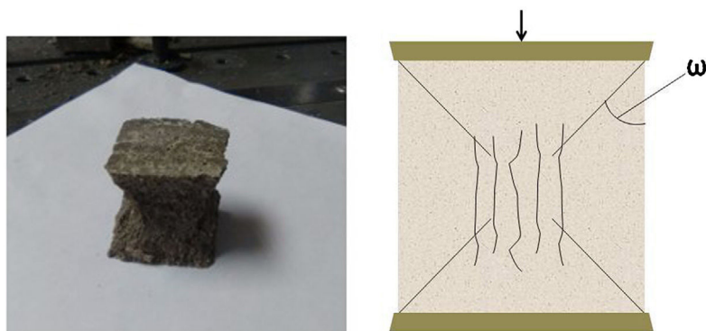
Figura 6 – Rotura típica de morteros de cemento.
