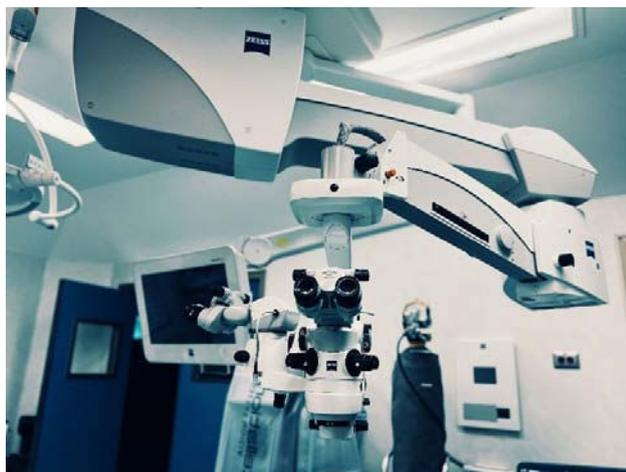
Figura 8. Microscopio anclado al techo exclusivo para cirugía ocular (Lumera 700, Zeiss) con sistema de alineación digital de LIO CALLISTO eye
