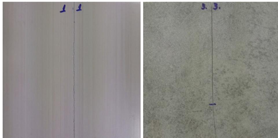
**Figura 4 – Comportamiento en el corte para la pieza AZ (izquierda) y POR-B (derecha). Profundidad de entalla 0,2 mm.**
