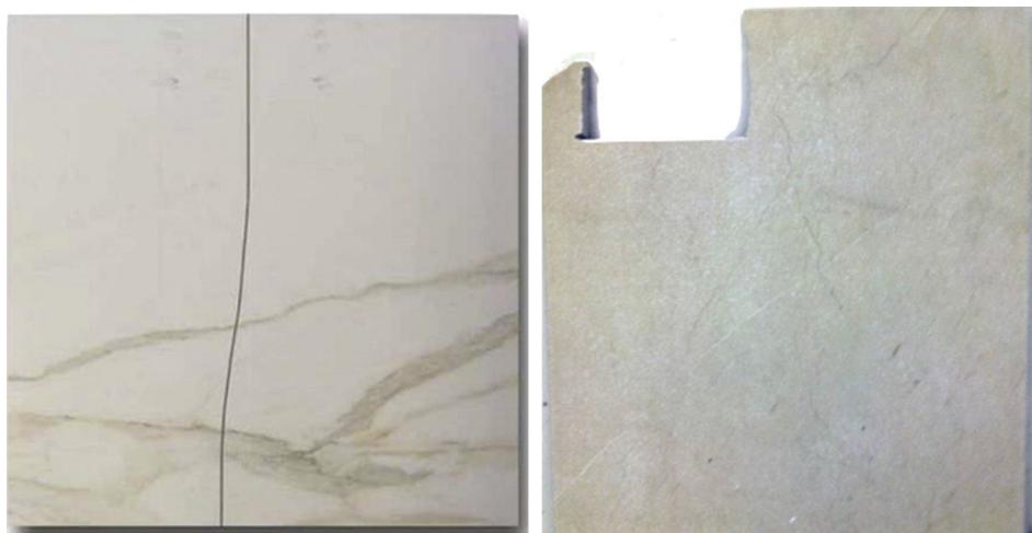
**Figura 1 – Cortes defectuosos en baldosas de gres porcelánico. Izquierda: cortadora manual, derecha: inserto con radial.**
