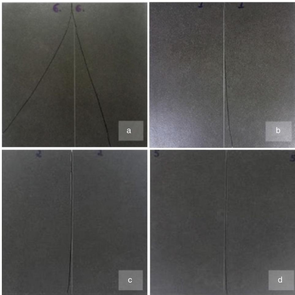
**Figura 5 – Comportamiento en el corte para la pieza POR-M con diferentes profundidades de entalla. a) 0,2 mm; b) 0,25 mm; c) 0,3 mm y d) 0,4 mm.**
