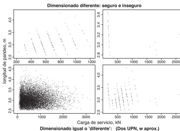
Figura 9. Aproximación con  $\omega$ -ap, carga y altura: caso UPN  $\omega$ -ap.
