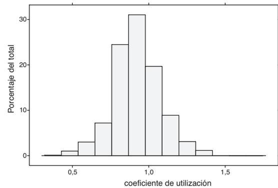
Figura 11. Dimensionado aproximado:  $\kappa$  estimada en gama de perfiles «20».
