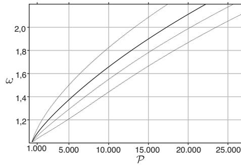
Figura 3. Problema  $\mathcal{P}$  y factor de pandeo  $\omega$ . Detalle.
