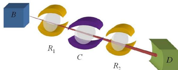
Figura 2. Esquema del dispositivo para la medición no destructiva de fotones.
