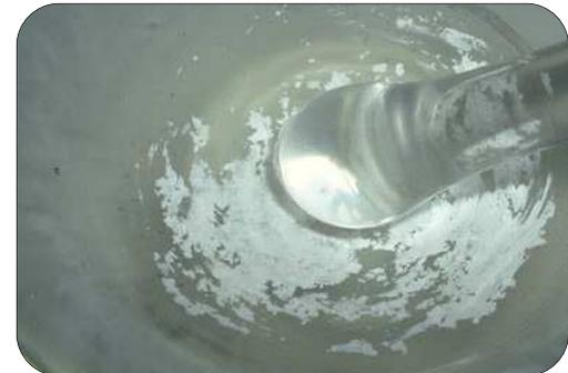
Figura 5. Pasta obtenida entre la triamcinolona y el Tween 80. Al añadir el agua la triamcinolona se mantendrá dispersa de forma homogénea y no formará aglomerados
