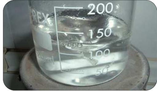
Figura 4. Imbibición de la carboximetilcelulosa sódica en el agua mediante agitación mecánica durante al menos 20-30 min
