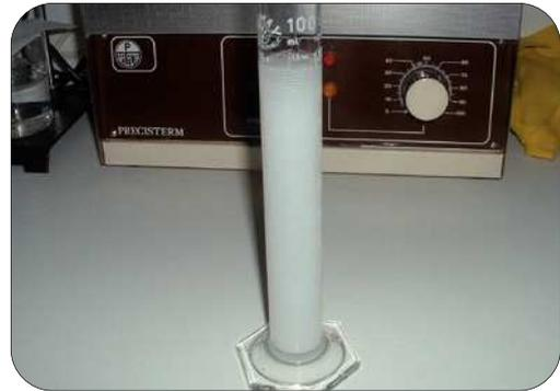
Figura 7. Prueba del tiempo de sedimentación de la suspensión elaborada
