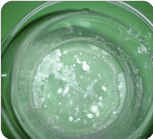
Figura 3. Vista frontal de una suspensión donde se observan fenómenos de aglomeración
