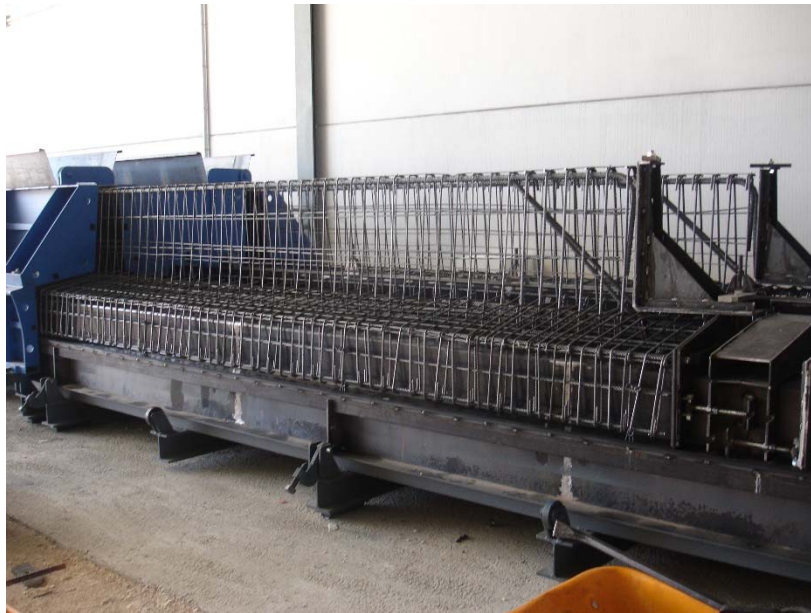
Figura 6. Armadura de la grada montada sobre la bancada de prefabricación
