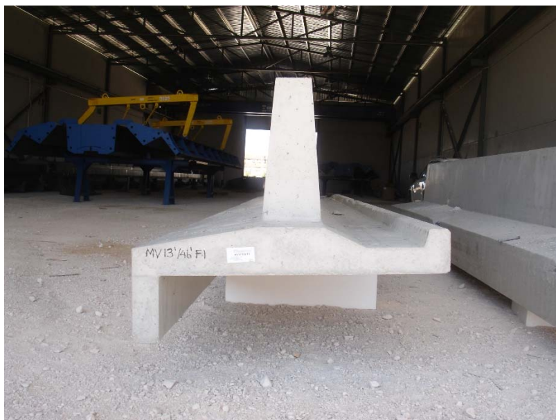
Figura 4. Sección tipo (invertida) de grada de graderíos medio y alto
