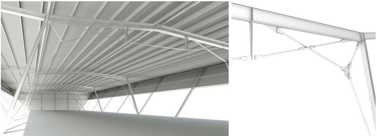
Figura 9. Vista detalle del pórtico skelsion
