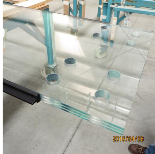
Figura 6. (B) Mecanizado de contrafuerte.
