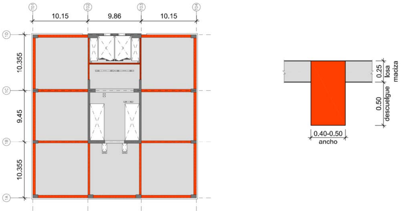
Figura 6. Edificio Torre. Planta tipo
