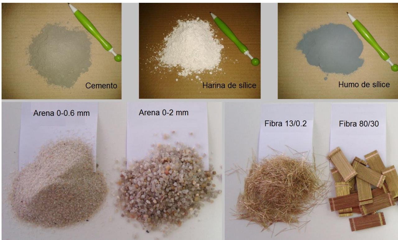
Figura 1. Materiales comunes en España para la fabricación de un HMAR [4]
