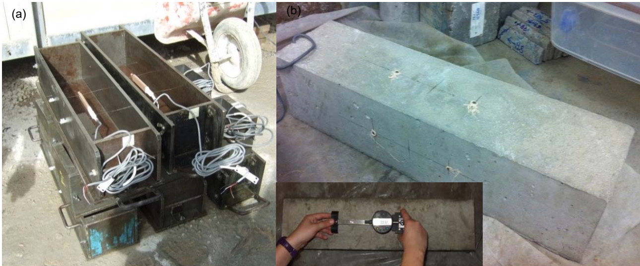
Figura 2. (a) Galgas extensométricas colocadas en el centro de la probeta y (b) puntos de comparación anclados en la cara superior y lateral para medir deformaciones longitudinales.
