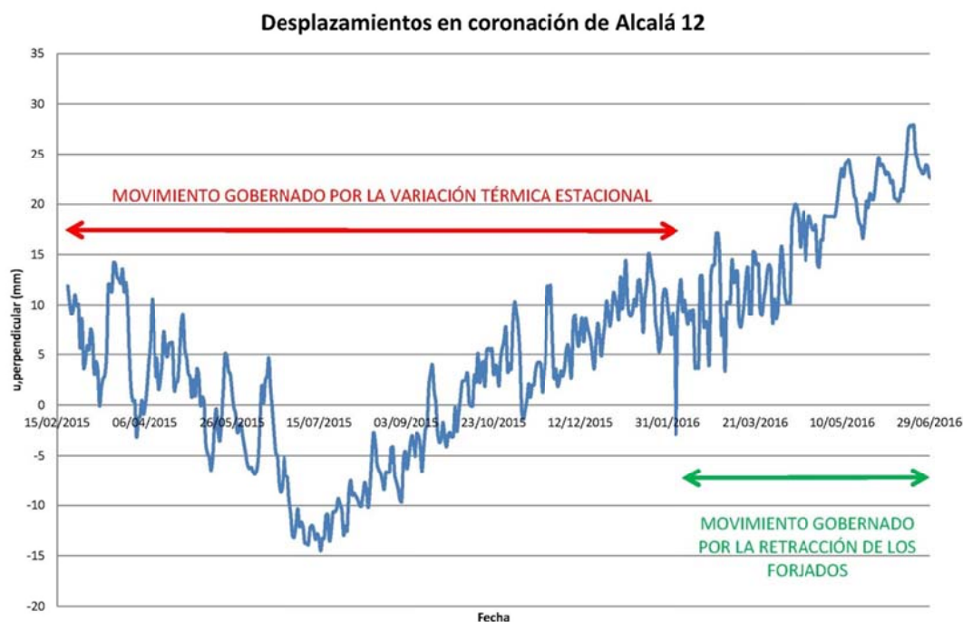
Figura 14. Desplazamientos perpendiculares al plano de fachada en la coronación de Alcalá 12. Valores medios diarios.
