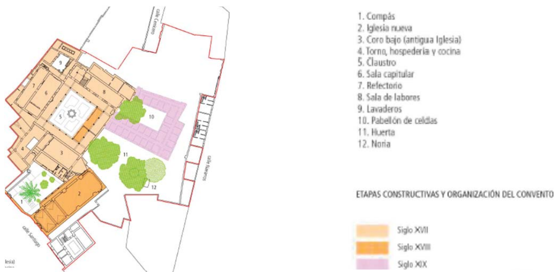
Figura 1. Etapas constructivas y organización del convento
